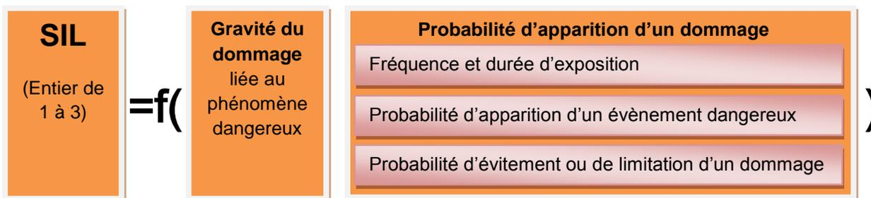
Figure 5 : Paramètres utilisés dans l'estimation du risque
