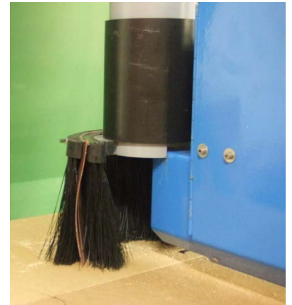
Détail brosse captage et canal de transfert
