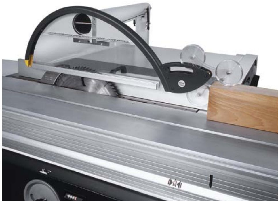
Protecteur aspirant CX matic pour la scie circulaire à table et à format
