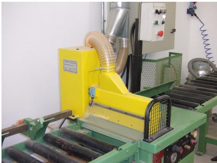
Protecteur Theta pour tronçonneuse à lame escamotable (issu d'une étude INRS)
