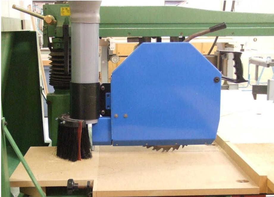
Dispositif de protection CAPRAD pour la scie circulaire radiale
