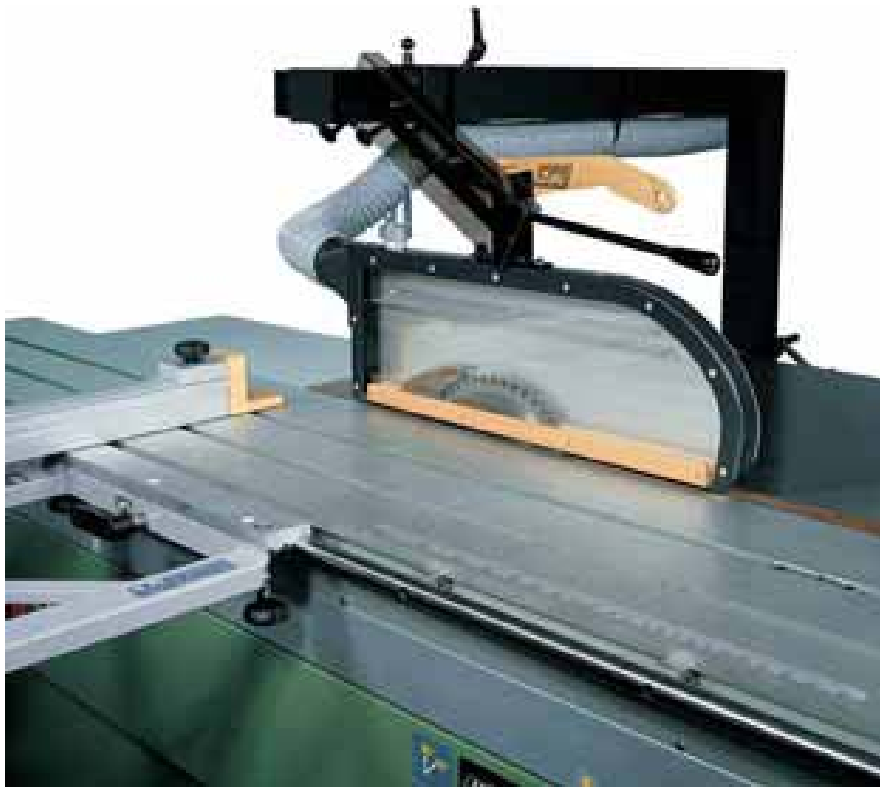
Protecteur aspirant Beta pour la scie circulaire à table et à format
