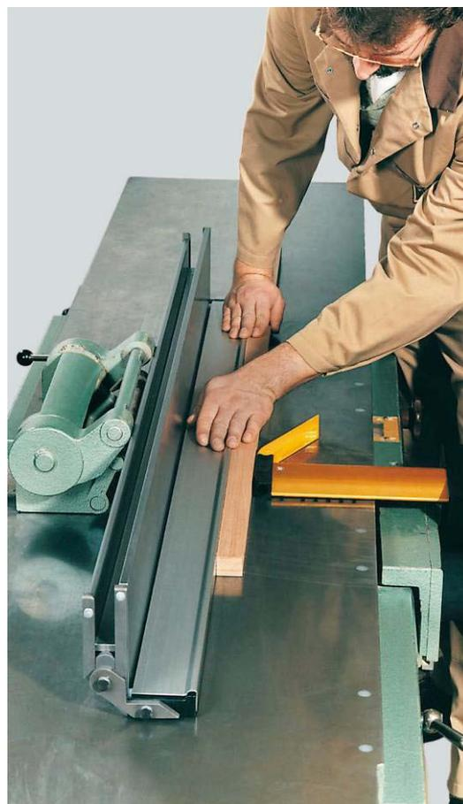
Guide auxiliaire de dégauchissage
