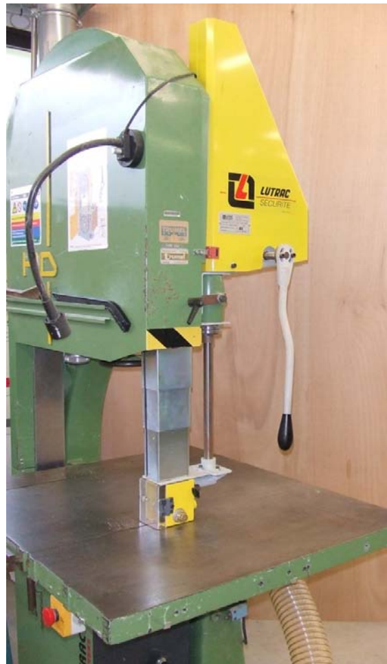
Protecteur réglable ADÉA pour la scie à ruban (issu d'une étude INRS) Brevet INRS n° FR2647384
