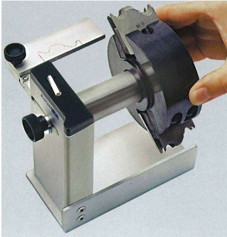
Dispositif pour relever un profil d'outil
