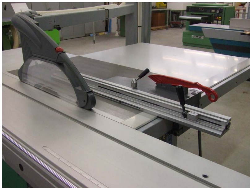
Poussoir intégré au guide VECTRAL (issu d'une étude INRS) Brevet INRS n° FR2743325
