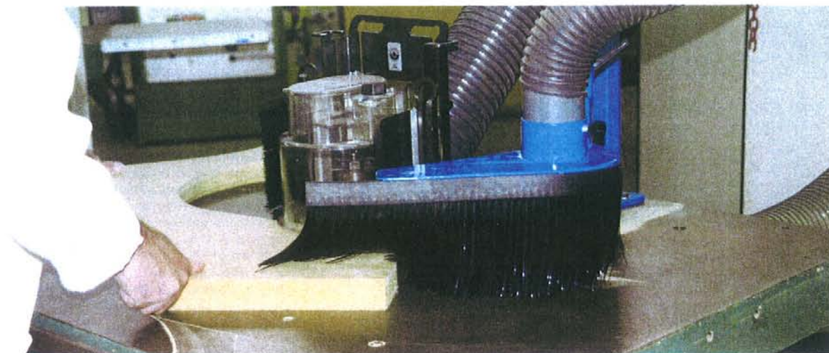
Le Captou est un dispositif auxiliaire de captage des poussières pour toupies travaillant à l'arbre.
