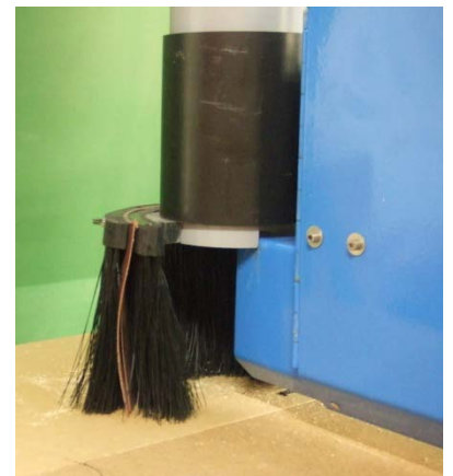
Détail brosse captage et canal de transfert
