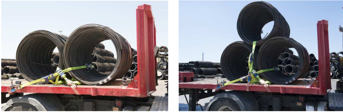
Figure 13. Composition des chargements testés en vraie grandeur lors d'un essai de freinage d'urgence.
