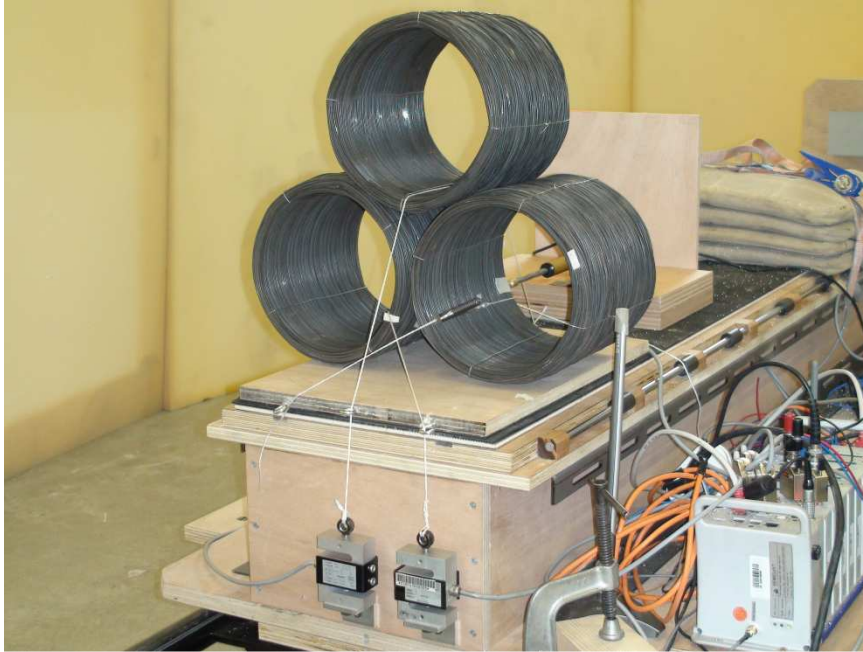
Figure 12. Essai de décélération latérale.
