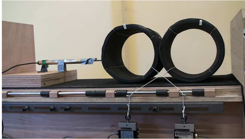
Figure 8. Arrimage croisé d'un lot de 2 couronnes.
