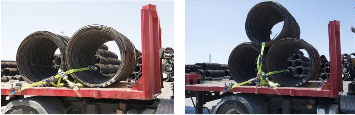
Figure 13. Composition des chargements testés en vraie grandeur lors d'un essai de freinage d'urgence.
