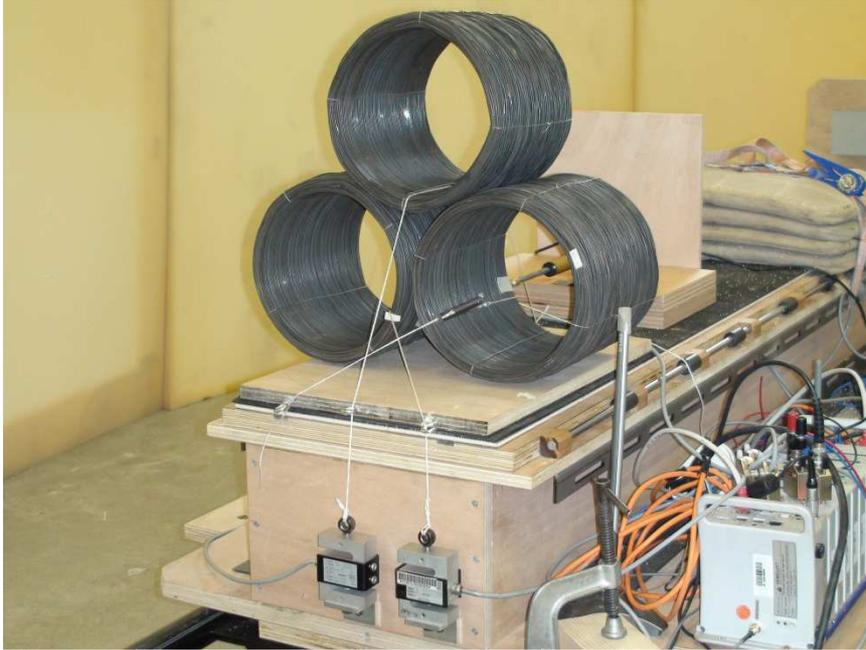
Figure 12. Essai de décélération latérale.
