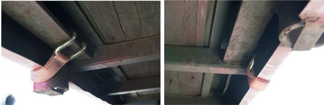
Figure 16. Positionnement des crochets d'arrimage.
