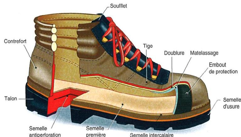
Figure 1. Les différents éléments d'une chaussure de sécurité.
