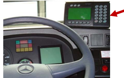
Figure 8 : Ecrans relatifs au SAEIV dans la cabine du bus au poste de travail conducteur-receveur
