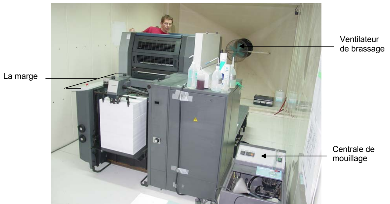
Photo 1. Machine SM 52 et ses équipements dans la cabine
