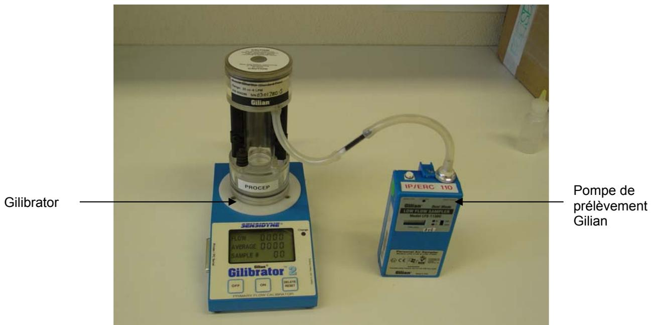
**Photo 2. Calibration des pompes de prélèvement**
