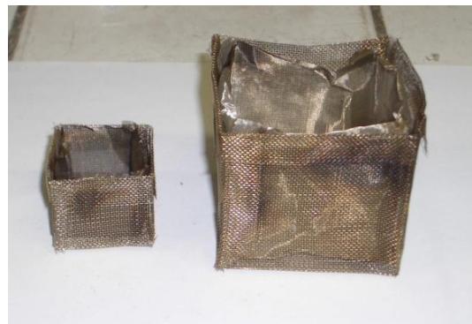
Figure 4 : Four isotherme à paniers et paniers cubiques de 25 et 50 mm
