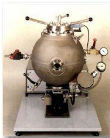
Figure 8 : Photographie de la sphère d'explosion de 20 L
