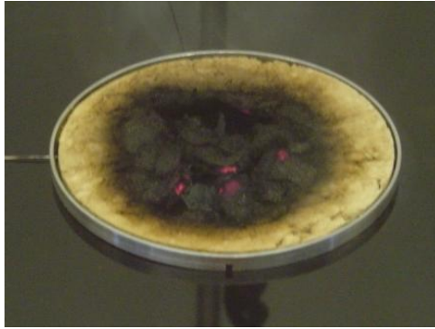
Figure 3 : Test d'inflammation en couche de 5 mm
