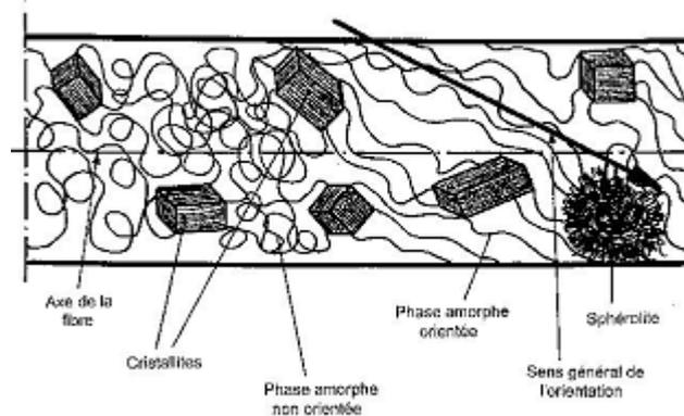
**Figure 5** Structure semi-cristalline d'une fibre
