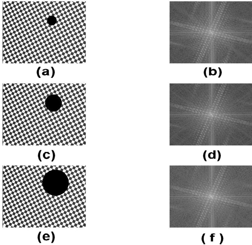
Figure 24 : (a)(c)(e) insertion d'un objet noir dans l'image d'une mire, (b)(d)(f) spectre de Fourier des images (a)(c) et (e) respectivement
