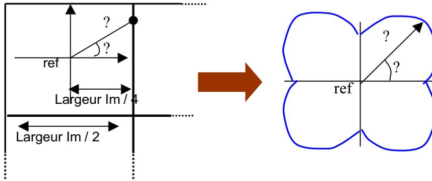
Figure 21 : signature "théorique" des contours en coordonnées polaires
