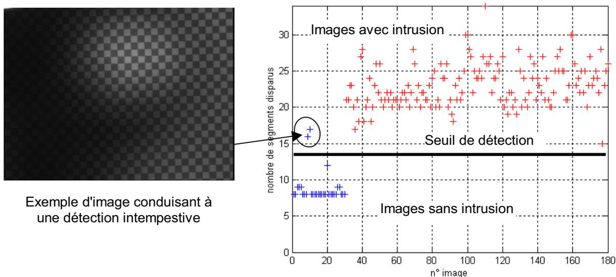
Figure 31 : résultats de l'algorithme par disparition de segments
