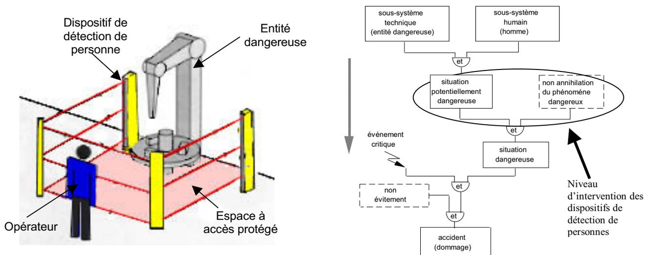
Figure 2 : chaîne des événements conduisant à l'accident
