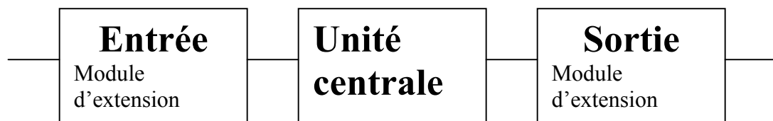
Diagramme de fiabilité de l'automate A
