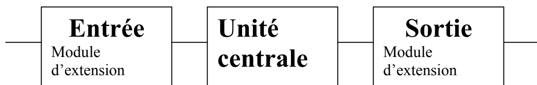
Diagramme de fiabilité de l'automate A
