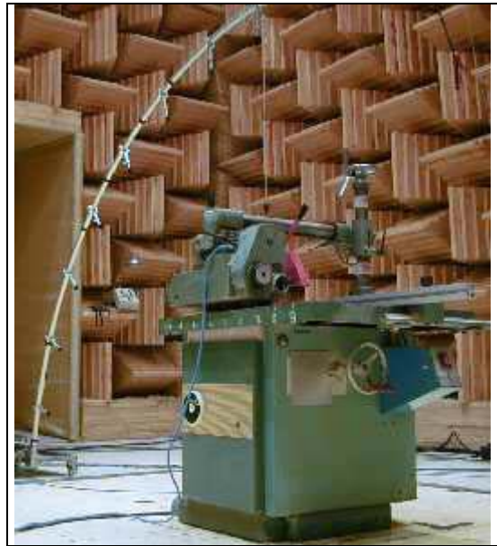
Photographie 1 : Scie à bois en chambre semi-anéchoïque
