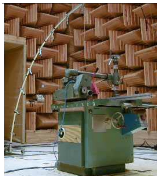
Photographie 1 : Scie à bois en chambre semi-anéchoïque
