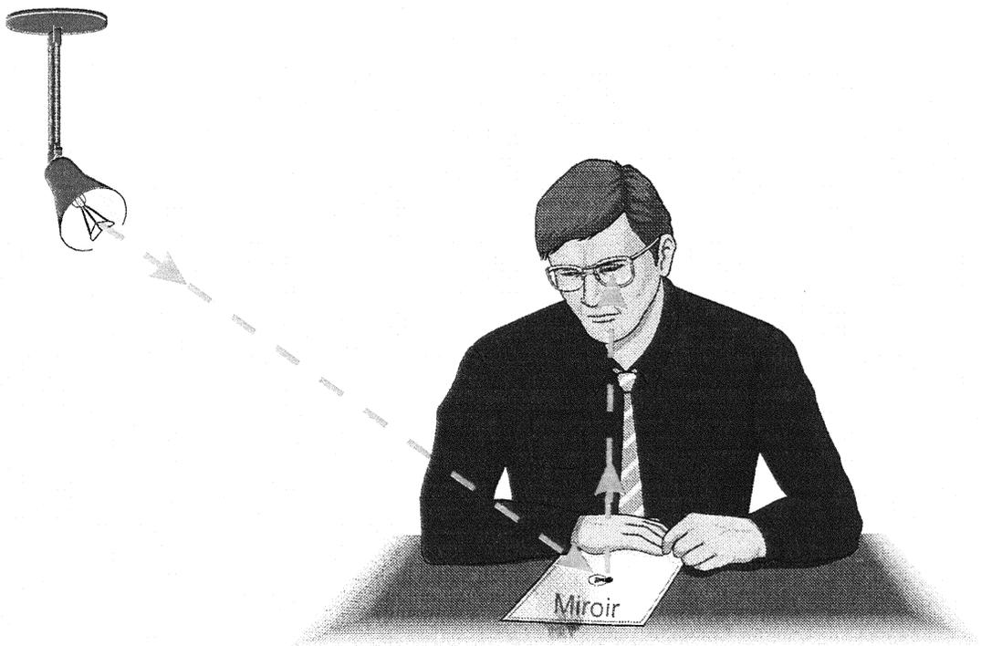
Figure 9.3. Utilisation d'un miroir pour identifier l'origine des réflexions
