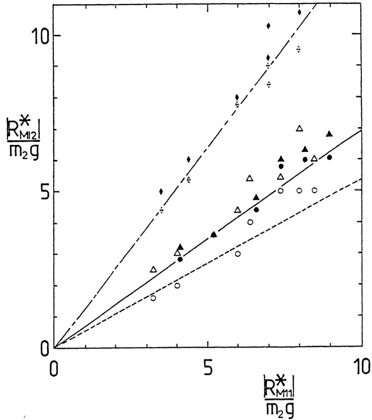
Fig. 7 : Relations entre les accroissements maximums de la réaction verticale  $|R^*_{M11}|$  et les accroissements maximums des réactions horizontales  $|R^*_{M12}|$  du banc d'essais, à la suite de la chute d'un sac sphéro-conique de 50 kg sur l'échafaudage, d'une hauteur inférieure ou égale à 0,5 m pour les trois configurations de ce matériel  $k = a, b, c$ .
