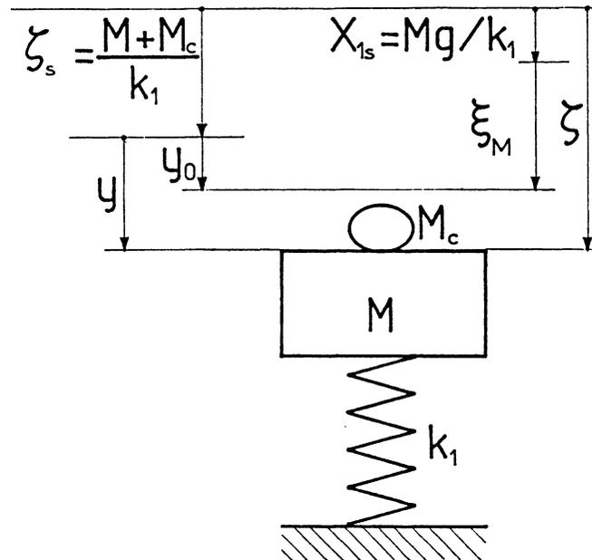
Fig I-3 : Choc additionnel sur un échafaudage de couvreur.
