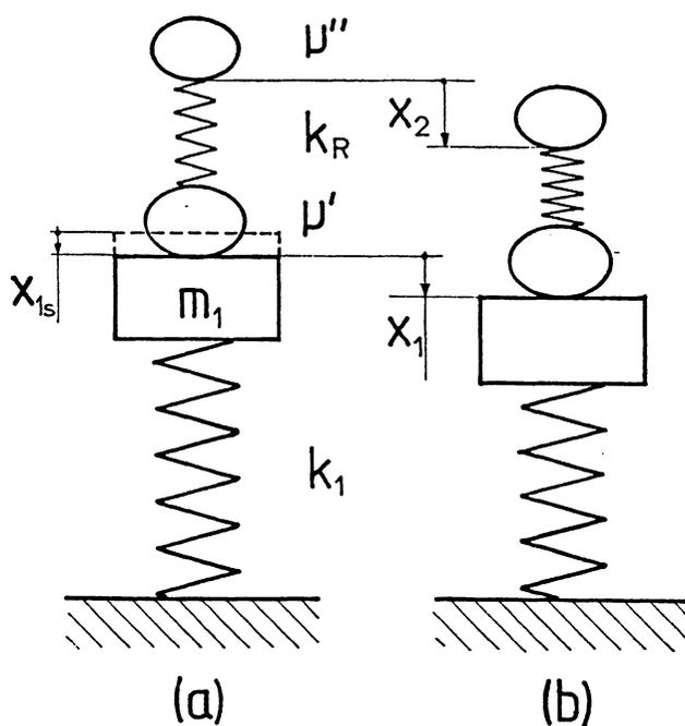
Fig. II-1 Modélisation d'une chute de plain-pied sur un échafaudage de couvreur.
