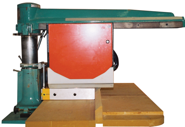
Vue de gauche de la machine : bloc moteur-lame en position repos et en position travail
