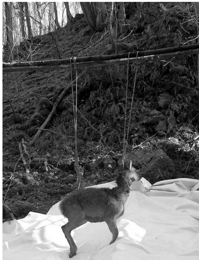
Figure 2 - Disposition de la cible lors des tirs : suspendue à une charpente en bois devant un éboulis au pied d'une barre rocheuse.
