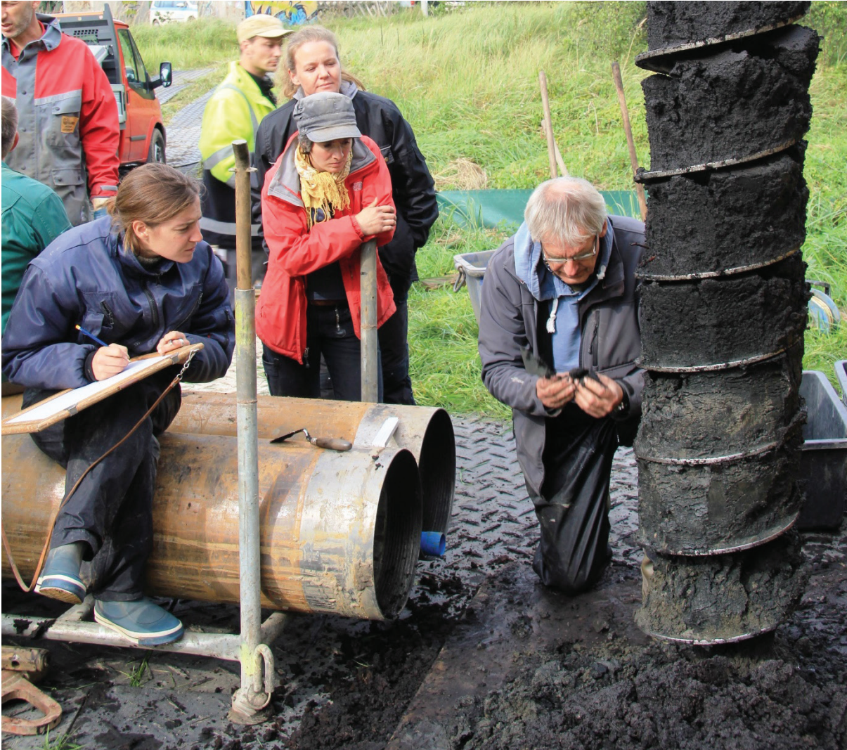
Figure 4: Ahrensburg „Stellmoorteich“: Alle abgeteufte Bohrungen enthielten zahlreiche Funde der Ahrensburger-, bisweilen auch der älteren Hamburger Kultur. Die dunkelbraun gefärbten Sedimente entstammen der Nacheiszeit, darunter und dunkelgrau gefärbt sind deutlich die Beckenablagerungen des späteiszeitlichen Sees erkennbar.
