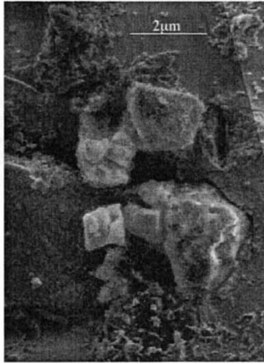
FigCosmo5 : Grains de silice observés au microscope électronique à balayage. Les fausses couleurs surimposées à l'image traduisent l'intensité de l'anomalie isotopique (excès de  $^{18}\text{O}$ ).
