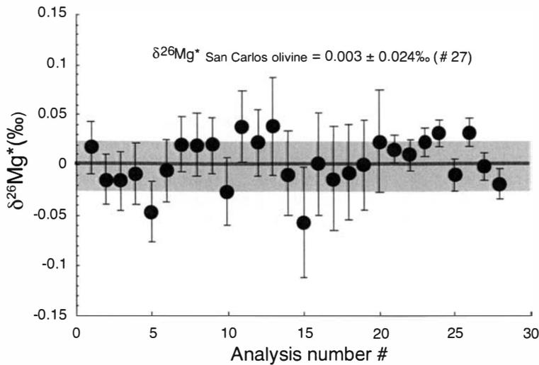
Fig.CPTP1 : Reproductibilité des mesures d'excès de  $^{26}\text{Mg}$  (écarts à la droite de discrimination de masse) dans une olivine terrestre standard (Chaussidon *et al.*, LPSC2006). Les mesures sont réalisées avec la sonde ionique ims 1270 en multicollektion avec 3 cages de Faraday pour la mesure des trois isotopes du Mg ( $^{24}\text{Mg}$ ,  $^{25}\text{Mg}$  et  $^{26}\text{Mg}$ ).
