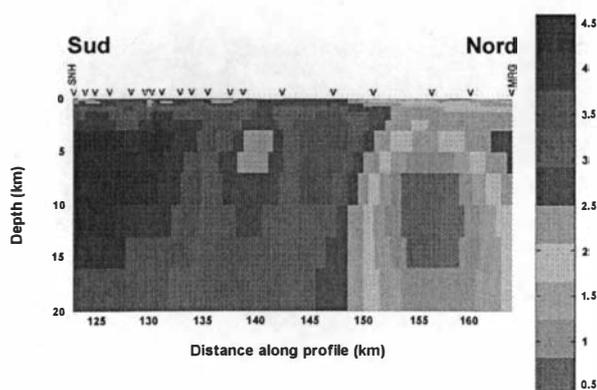
Fig. Geodyn5. Résistivité électrique apparente du sous-sol le long du profil s'étendant de Faymont à Rambervillers, soit sur 41 km.
