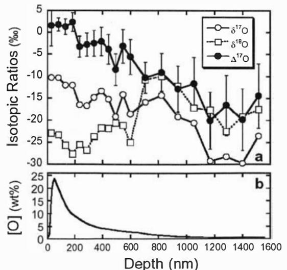
FigCosmo3 : Profil en profondeur avec la sonde ionique des compositions isotopiques de l'oxygène dans un grain de métal du sol lunaire Apollo 17 79035. Un composant solaire implanté ayant un enrichissement en  $^{16}\text{O}$  de 20‰ est présent en profondeur
