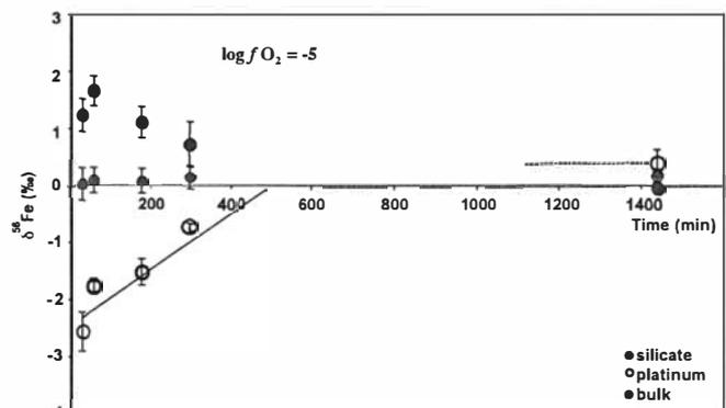
FigCosmo11 : Fractionnement isotopique expérimental du Fer entre phase métal et silicate, à  $f\text{O}_2$  constante et en fonction du temps
