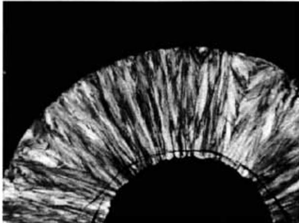
Fig. 1. Approche expérimentale de la cinétique de cristallisation d'un verre, juste au-dessus de la transition vitreuse: (a) microphotographie des cristaux aciculaires de larnite précipités à partir de la bordure d'une bille de verre; (b) diagramme montrant la longueur des aiguilles en fonction du temps à différentes températures.
