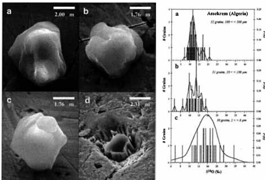
Figure 10: Image MEB de grains quartz inférieurs à 10μm provenant de sols, illustrant différentes morphologies (a, b, et c). La photo d représente un grain inclus dans l'or après analyse à la sonde ionique. 30 à 50% de ce grain de 2 μm a été détruit. A droite, les spectres représentent la distribution en obtenus par sonde ionique sur différentes populations granulométriques dans un échantillon de sol algérien (Aléon et al. 2002, GCA, 66).
