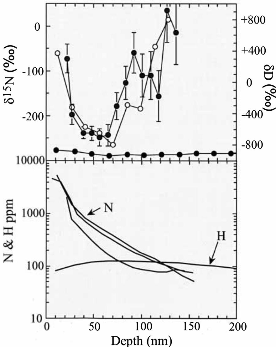
Fig 2 : Profil en profondeur par sonde ionique dans un grain du sol lunaire 79035. Ce grain contient de l'H sans D, c'est à dire de l'H solaire. L'N du vent solaire implanté dans les premiers 50 nm de profondeur a un  $\delta^{15}\text{N} < -250\text{‰}$ .
