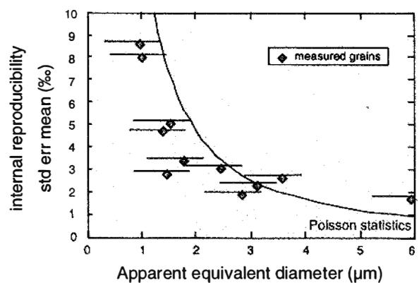
**Figure 2 -** Précision (erreur sur la moyenne) des mesures de  $\delta^{18}\text{O}$  sur des grains de standards de magnétite en fonction de la taille des grains. La statistique de Poisson correspond à la meilleure précision théorique que l'on pourrait atteindre. Elle est calculée pour des grains sphériques.
