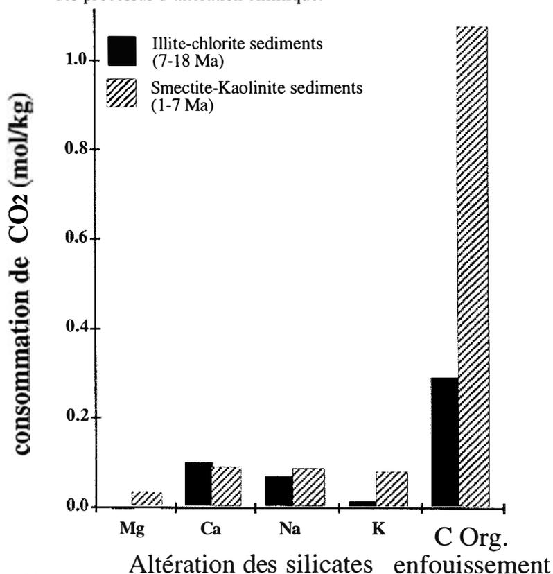
**Figure 3** - Consommation de  $CO_2$  atmosphérique par altération des silicates et enfouissement de matière organique établie par différence de composition chimique entre le matériel érodé (source himalayenne moyenne) et les sédiments accumulés dans le cône du Bengale. Le flux d'enfouissement du C organique représente un puits de  $CO_2$  au moins trois fois plus important que l'altération des silicates pour l'érosion himalayenne (*France-Lanord et Derry, 1997*).
