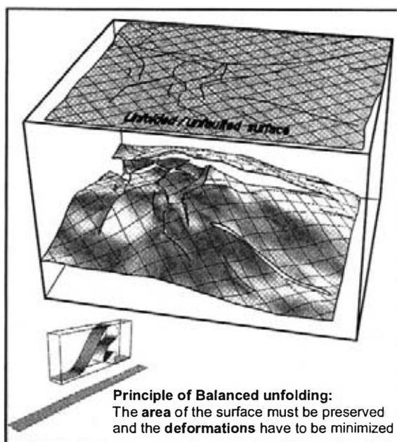
**Figure 3 -** Exemple de surfaces faillée triangulées restaurées et dépliées utilisant une méthode de paramétrisation globale : la surface des horizons est conservée avec une précision de  $10^{-3}$  (Données Elf)
