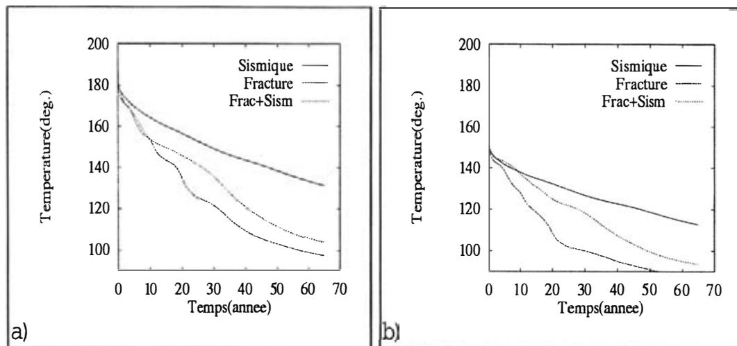
**Figure 6-** Température en fonction du temps des fluides extraits de deux réservoirs géothermiques situés à 5000m (gauche) et 3500m (droite). Trois hypothèses sont étudiées: (a) milieu poreux (sismique); (b) milieu fracturé; (c) milieu mixte. La durée de vie de l'échangeur géothermique de Soutz varie entre 25 et 70 ans selon les hypothèses admises et la profondeur du réservoir.
