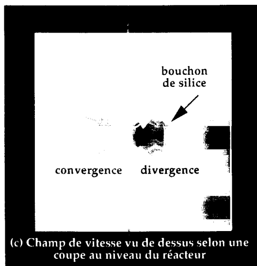
Figure 2-Thème 3: Modélisation des transferts de chaleur et de silice autour d'un réacteur naturel de fission d'Oklo (Gabon, thèse B. Gérard, 1997): (a) le champ de température atteignant selon les hypothèses plus de 400 degrés au coeur, traversé par un écoulement fluide initialement uniforme; (b) la solubilité de la silice variant avec la température, cela crée des zones de dissolution en amont du réacteur, associées à une augmentation de la perméabilité et des zones de précipitation en aval, associées à une baisse de la perméabilité ("bouchon de silice"). (c) ceci provoque une convergence de l'écoulement en amont du réacteur et une divergence en aval; (d) évolution des zones de dissolution et de précipitation en 3D au cours du temps
